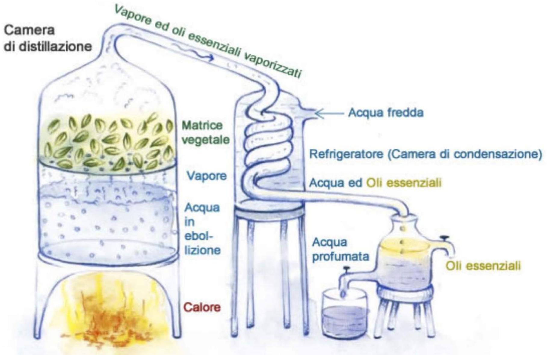
La distillazione a vapore d'acqua si usa per estrarre e separare delle sostanze non idrosolubili con una temperatura di ebollizione inferiore a quella dell'acqua. Il vapore acqueo funge come vettore di trasporto per le sostanze che si desiderano separare dalla materia greggia.
